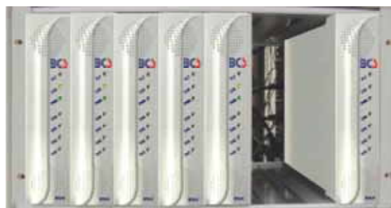
RT10000 机架，容纳 8 个 GTU
